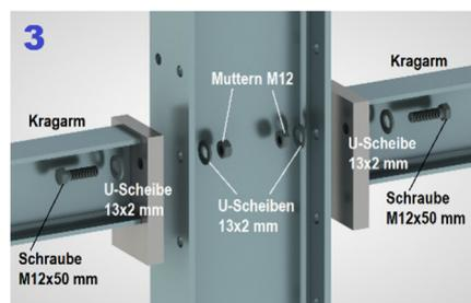
Für die Schraubverbindung der Kragarmbefestigung gilt: Nicht vorgespannte Schraubengarnituren sind entsprechend der Ausführungsnorm EN 1090-2 mindestens handfest anzuziehen, wobei darauf zu achten ist, dass diese dabei nicht überlastet werden. Um einen einheitlichen handfesten Zustand zu erzielen kann mehr als ein Anziehdurchgang notwendig sein. Handfest = Zustand, der von einer Person mit einem Schraubenschlüssel normaler Größe ohne Verlängerung erreicht werden kann.
